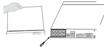
Coloque a tampa novamente e aperte os parafusos.
