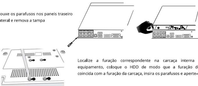
Localize a furação correspondente na carcaça interna do equipamento, coloque o HDD de modo que a furação dele coincida com a furação da carcaça, insira os parafusos e aperte-os.
